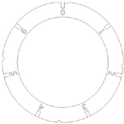
Drehen Sie den Schalter an der Vorderseite des Geräts. Drehen Sie den Drehknopf, der der Platte entspricht, von "0" auf die gewünschte Heizstufe, zwischen 1 und 6.
